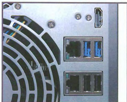
配備雙 Gigabit LAN 可支援 Link Aggregation，而 HDMI 則可接駁電視並播放 4K 影片。
