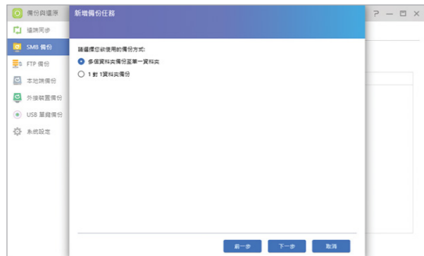
5 | 選擇備份方式： • 多對一備份：多個資料夾備份至單一資料夾。 • 一對一備份：1 對 1 資料夾備份，即兩個資料夾的內容將會相同。
