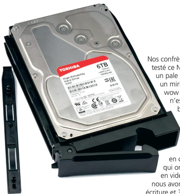
Montage sans vis et aucune vibration, mention bien pour la fixation !
