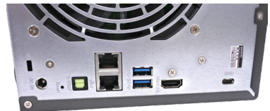
▲ 除了正面的一組 USB 3.0 之外，背面的設計提供有 2 組的 GigaLAN、2 組 USB 3.0 Type A 與 1 組 Type C，還有 HDMI 2.0 與 S/PDIF 輸出
