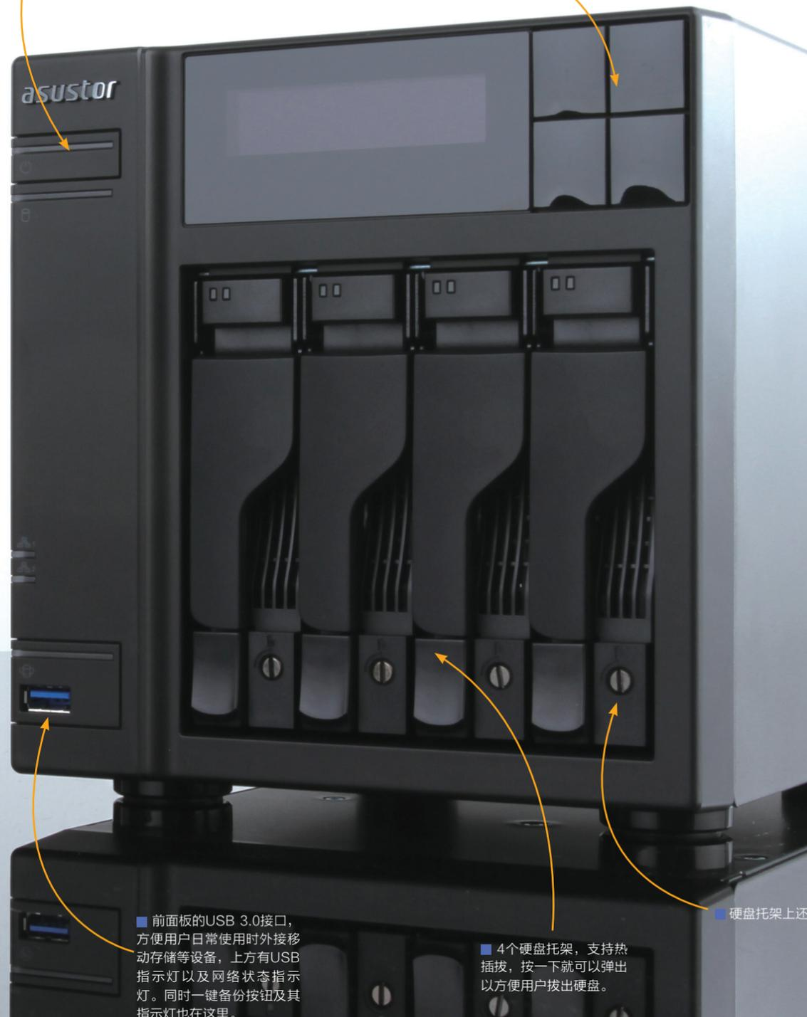
前面板的USB 3.0接口,方便用户日常使用时外接移动存储等设备,上方有USB指示灯以及网络状态指示灯。同时一键备份按钮及其指示灯也在这里。
