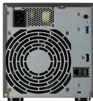
▲機身後提供兩個USB 2.0與1個USB 3.0連接埠，還有HDMI埠可輸出影音
