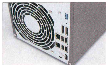
AS-604T支援HDMI，且具備雙GbE網路，I/O處還有1個USB 3.0可使用。
