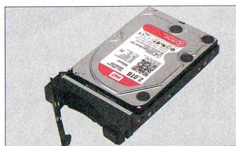
硬碟槽可從正面熱插拔，本次測試是搭配NAS專用的WD紅標2TB硬碟。
