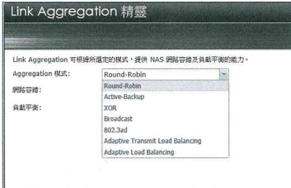
Asustor NAS產品的一大特色是各款式機型都內建2組GbE埠，用戶可藉此利用2組GbE埠建立頻寬匯聚、故障失效切換等應用，Asustor的ADM作業系統可提供Linux內含的所有7種容錯與負載平衡模式。
