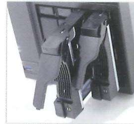
● 硬碟架採用抽取式設計，配合一字批安全鎖頭。
